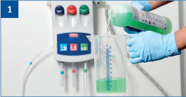
In einem Messgefäß werden zum Beispiel 800 ml eines Reinigungsproduktes gefüllt.
