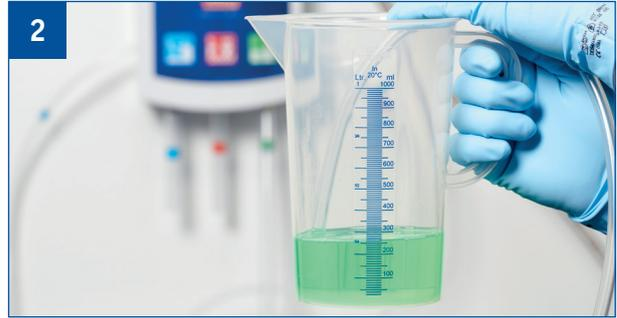
Der Ansaugschlauch wird in das Messgefäß bis zum Boden eingeführt und danach die Markierung abgelesen.
